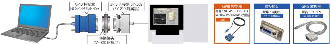
【产品组成】CD (含使用说明书 PDF 文件)、GPIB 连接器 SY-509、转换接头、软件使用授权合约
